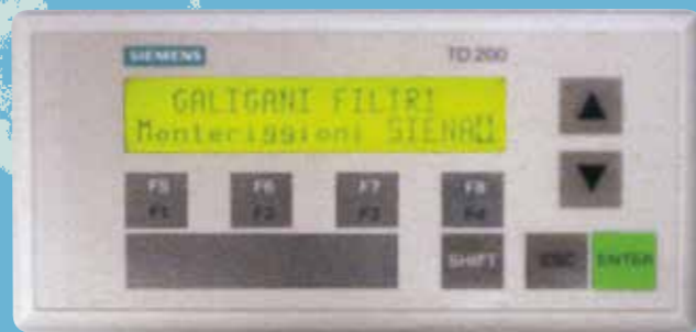
Siemens PLC installed on every filter press ПЛК Siemens, устанавливаемые на каждый фильтр-пресс
